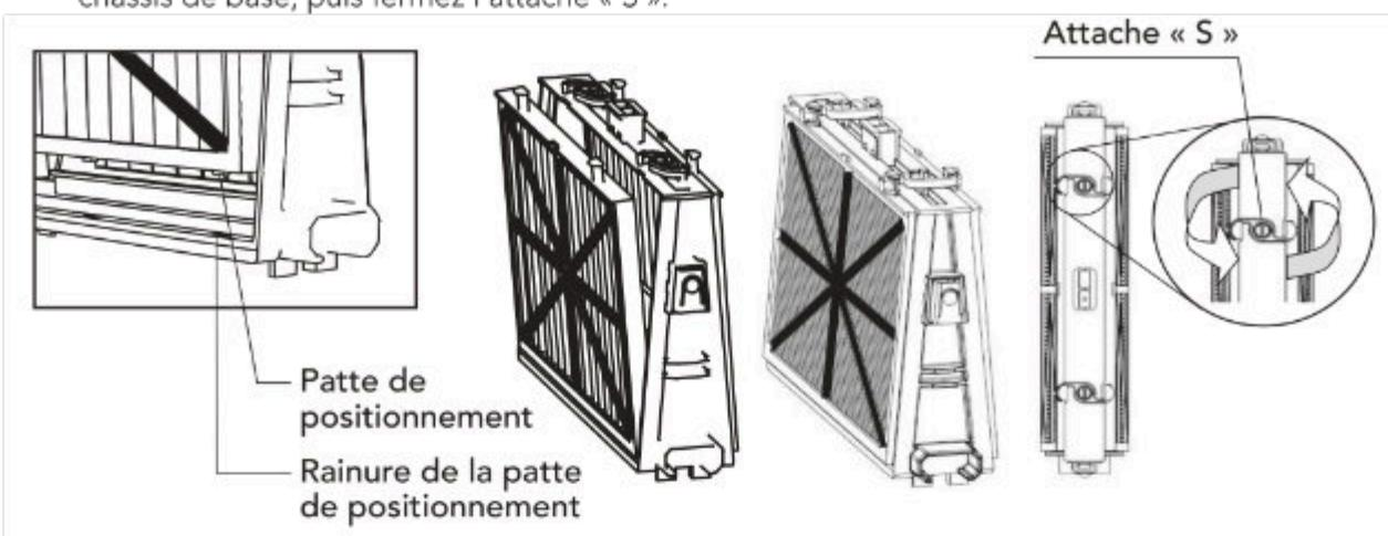
Réinstallez les châssis de base avec des filtres selon le schéma.
