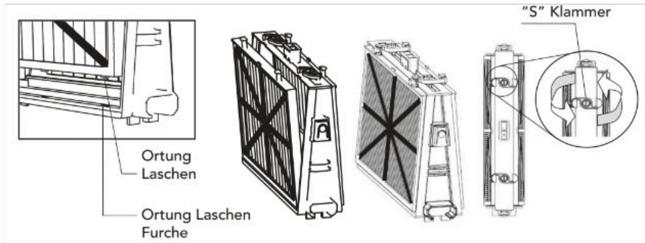
Installieren Sie den Grundrahmen mit den Filtern, entsprechend dem Diagramm.
