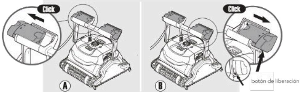
Para poner los flotadores de vuelta a su posición original: mientras presiona el botón de liberación de la base del flotador del mango - empuje el flotador del mango de vuelta.
