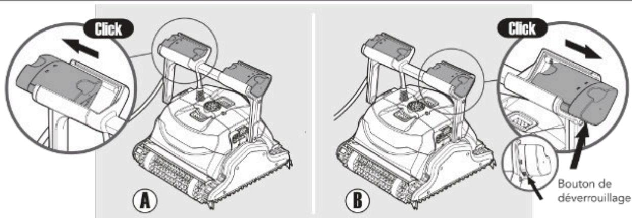
Pour remettre les flotteurs en position initiale, poussez chacun d'eux respectivement en arrière tout en appuyant sur le bouton de déverrouillage situé à sa base.
