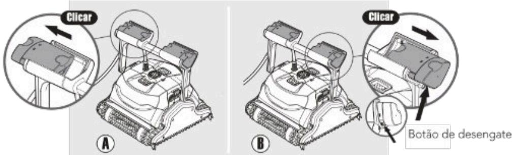
Para colocar os flutuadores de volta à sua posição original: enquanto pressiona o botão de desengate na base do flutuador da pega - empurre o flutuador da pega de volta.
