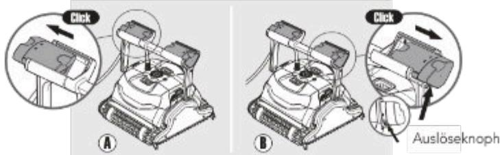
Um den Schwimmkörper wieder in seine ursprüngliche Position zurückzuschieben: schieben Sie den Griff-Schwimmkörper zurück, während Sie auf den Auslöseknopf auf der Basis des Griff-Schwimmkörpers drücken.
