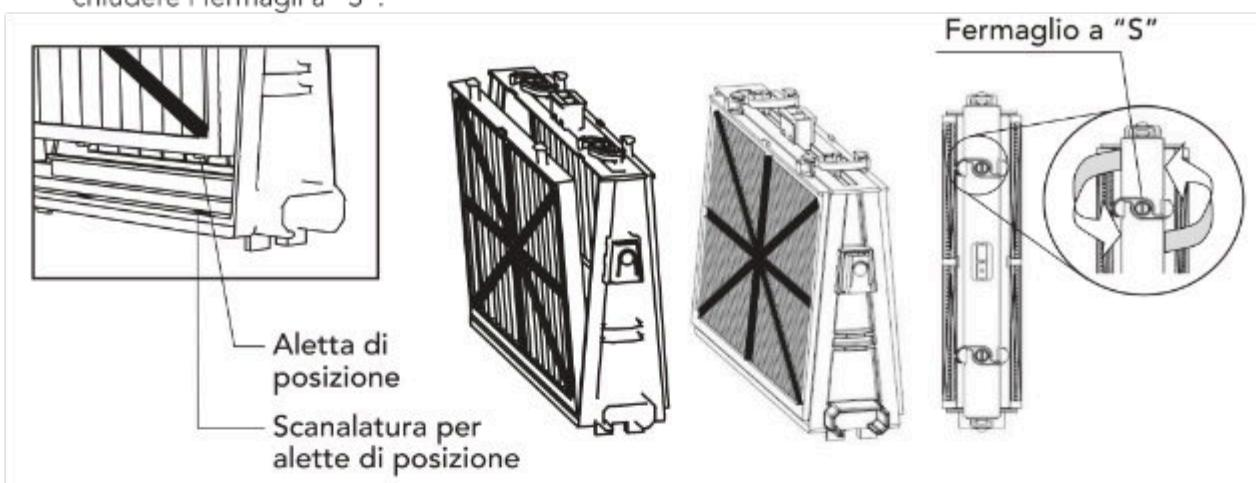
Re-istallare i telai di base con i filtri secondo il diagramma.
