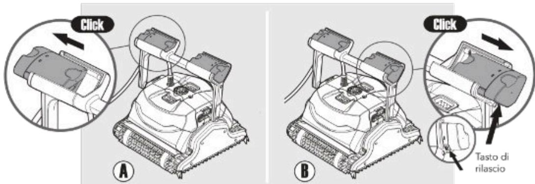
Per spostare i galleggianti di nuovo nella loro posizione originale: premendo il tasto di rilascio alla base del galleggiante del manico – spingi indietro il galleggiante del manico.
