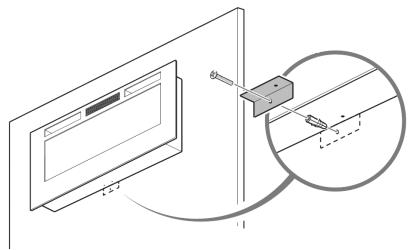
6. Verschrauben Sie nun mittels zweier weiterer Schrauben die Stützkante mit der Unterseite des Produkts.
