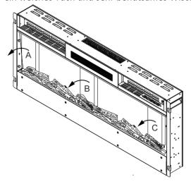
8. Heben Sie nun die Glasplatte an (es werden hierfür 2 Personen empfohlen) und setzen Sie diese wieder in die dafür vorgesehenen Aufnahmen an den Außenseiten des Gerätekörpers. Orientieren Sie sich an der folgenden Skizze.
