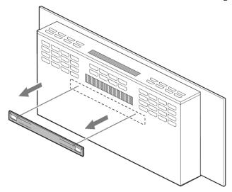
3. Nutzen Sie diese Montageleiste nun als Schablone, um an der gewünschten Position an Ihrer Wand 8 Bohrlöcher zu markieren. Achten Sie dabei auf eine genau horizontale Ausrichtung der Montageleiste und nehmen Sie ggf. eine Wasserwaage zuhilfe. Orientieren Sie sich an der folgenden Skizze.
