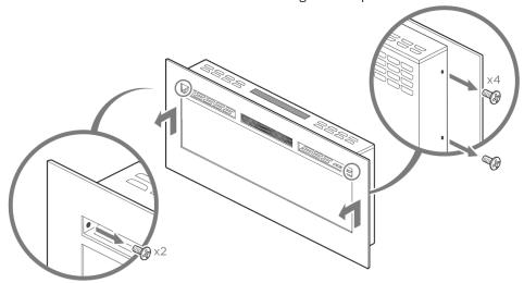
2. Entnehmen Sie die Montageleiste von der Rückseite des Produkts, indem Sie die 2 Schrauben entfernen, durch die die Leiste montiert ist. Orientieren Sie sich an folgender Skizze.
