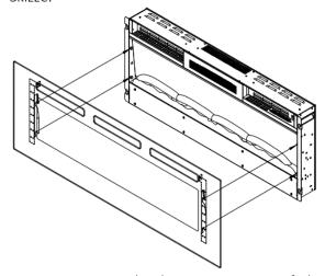
9. Setzen Sie nun wieder die insgesamt 6 graufarbenen Schrauben ein, die Sie im Schritt 1 der Vorbereitung entfernt hatten. Die Montage ist nun abgeschlossen.
