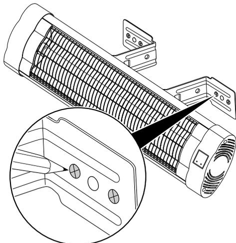
2. Bohren Sie die Löcher an den markierten Stellen in die Wand.
