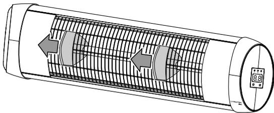
4. Wickeln Sie das Netzkabel vollständig ab. Achten Sie darauf, dass das Netzkabel nicht beschädigt ist, und beschädigen Sie es beim Abwickeln nicht.
