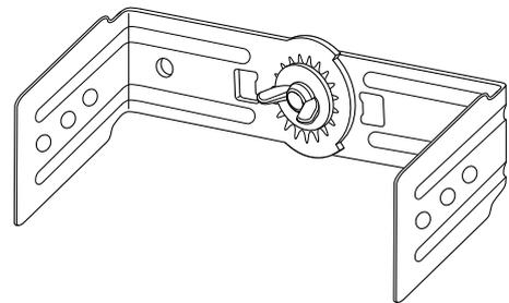
2. Schrauben Sie die Befestigungswinkel mithilfe der Befestigungsschrauben an der Halterung für die Wandmontage fest. Die Halterungen sind beliebig verstellbar. Empfohlen wird ein Abstand von 45 bis 55 cm zueinander.
