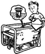
3. Füllen Sie Treibstoff nach bis zur roten Markierung am Treibstofffilter.
