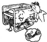
2. Setzen Sie den Messstab wieder in das Öleinfüllloch ein, ohne ihn zu drehen. Prüfen Sie den Ölstand.
