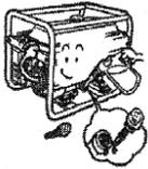
3. Sollte der aktuelle Ölstand sich unterhalb der unteren Markierung am Messstab befinden, füllen Sie Öl bis zur oberen Markierung nach.
