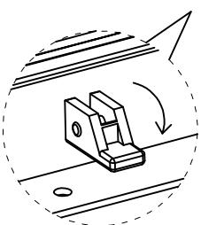
Lösen Sie die Verriegelung
