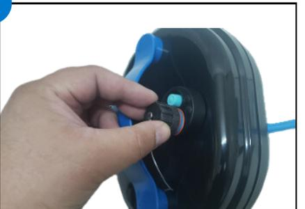
Nachdem Sie das Akkupack vollständig aufgeladen haben, ziehen Sie das Ladekabel ab und schrauben Sie die Kappe wieder auf den Stecker des Akkus. Ziehen Sie ihn anschließend Hand fest an.
