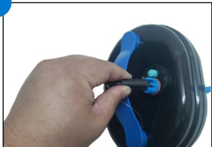
Stecken Sie das Ladekabel in das Akkupack. Sollte das Kabel nicht mit der korrekten Ausrichtung angeschlossen werden, wie durch die Aussparung vorgegeben, können Reiniger, Akkupack oder das Ladegerät beschädigt werden.
