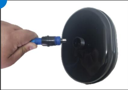
Nehmen Sie das Netzkabel des Roboters und schließen Sie es an das Akkupack an.
