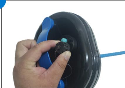
Schrauben Sie die Kappe des Ladesteckers auf der Oberseite des Akkupacks ab
