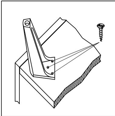
Die Schrankaufhänger dienen zur Kippsicherung des Schrankes und müssen grundsätzlich montiert werden.
