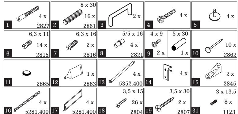
Das beigelegte Wandbefestigungsmaterial (Dübel und Schrauben) eignet sich nur für festes Mauerwerk (z.B.: Beton- oder Ziegelwände). Für andere Wandaufbauten sind eventuell Spezialdübel und andere Schrauben notwendig. Ziehen Sie gegebenenfalls eine Fachkraft zu Rate.
