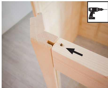
Bohrer 3 mm, 1 Stk. Schrauben 4 x 70 mm
