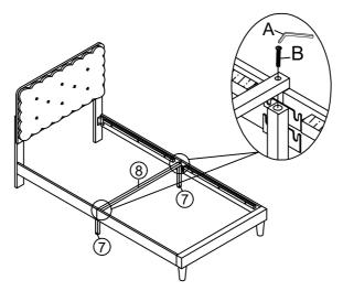
A Inbusschlüssel B Schrauben x 2
