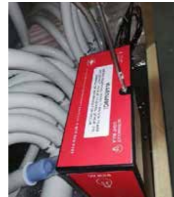
8. Schritt: Rote Abdeckung wieder festschrauben
