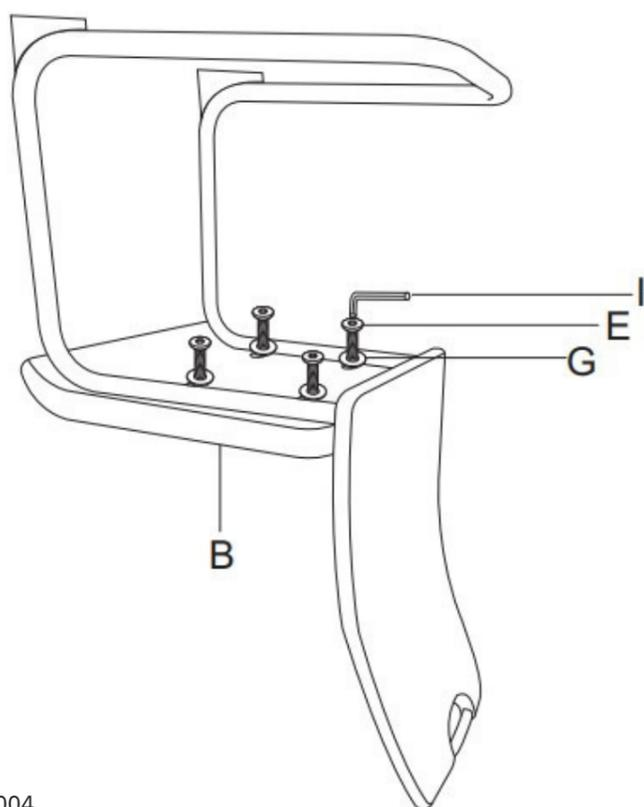
Montieren Sie die Sitzfläche (**B**) am Rahmen des Gestells mit den dafür vorgesehenen Unterlegscheiben (**G**) und den Schrauben (**E**).
