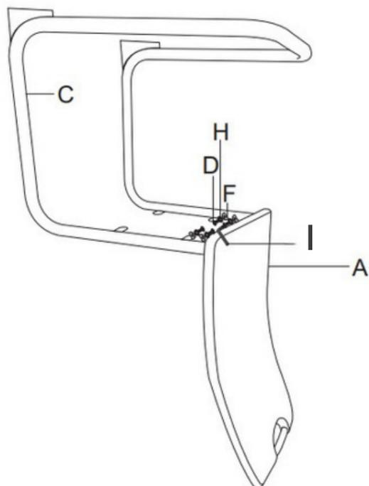
Befestigen Sie die Rückenlehne (**A**) am oberen Teil des Gestells (**C**). Verwenden Sie dazu die Schrauben (**D**), die Unterlegscheiben (**F**) und (**H**).
