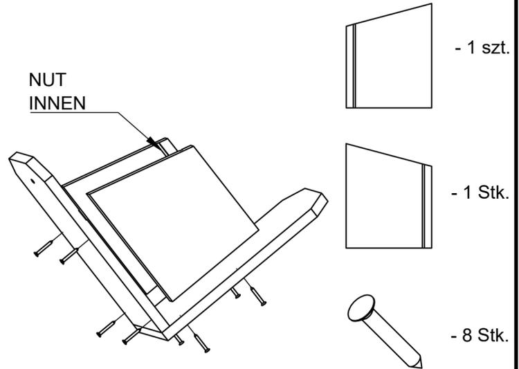
**SCHRITT 4: Setze die PLEXIGLASHALTERUNG auf den BODEN. Fixiere es, indem du 2 NÄGEL verwendest. Platziere anschließend das PLEXIGLAS und die Obere PLEXIGLASHALTERUNG mit 2 NÄGELN.**
