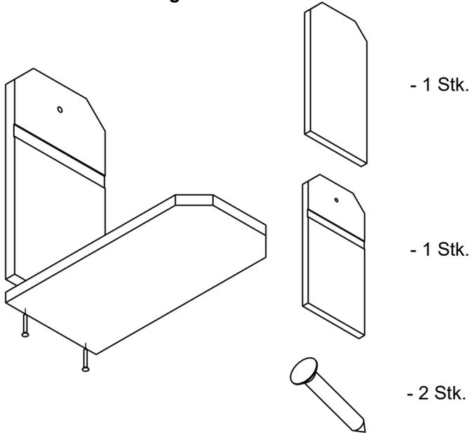
**SCHRITT 3: Befestige die SEITENTEILE (links und rechts am BODEN und an der RÜCKWAND. Verwende 8 NÄGEL, um die Teile zu fixieren.**
