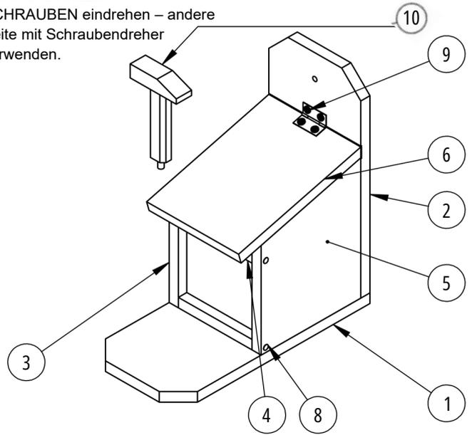
**SCHRITT 2: Setze den BODEN und die RÜCKWAND zusammen und befestige mit 2 NÄGELN**
