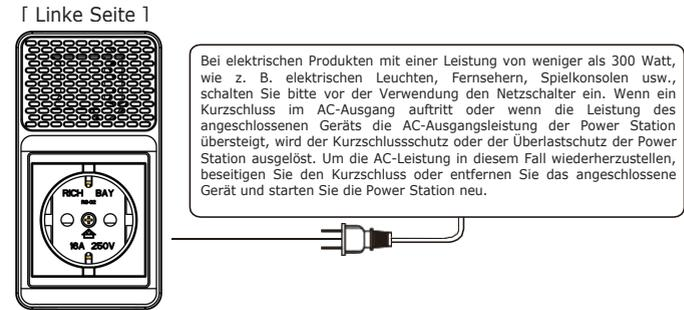
Wenn der AC-Ausgang einen Kurzschluss hat oder die Last die AC-Ausgangsleistung der Power Station übersteigt, wird der Kurzschlusschutz oder der Überleistungsschutz der Power Station ausgelöst. Um den Kurzschluss zu beseitigen, trennen Sie das angeschlossene Gerät und starten Sie dann die Power Station neu, um den AC-Ausgang zurückzusetzen.
