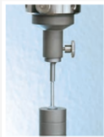
Test Nietdomausdrückkraft Mandrel push out test Essai de retenue de la tête de rivet
