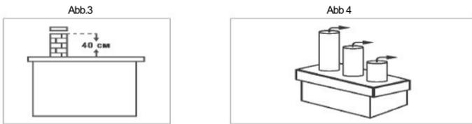
Der Schornstein darf keine Risse oder Brüche aufweisen. Zusätzlich muss er eine Wärmeisolierung haben, welche ein schnelles Abkühlen der Abgase verhindert, was zu Kondensation und verringertem Schub führt.
