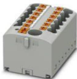
Verteilerblock, Grundklemme mit Einspeisung, Die Blöcke sind untereinander über den Leiterschacht brückbar. Passende Steckbrücken siehe Zubehör, Nennspannung: 450 V, Nennstrom: 24 A, Anschlussart: Push-in-Anschluss, Push-in-Anschluss, Anzahl der Anschlüsse: 13, Querschnitt: 0,14 mm<sup>2</sup> - 4 mm<sup>2</sup>, AWG: 26 - 12, Breite: 41 mm, Höhe: 21,7 mm, Farbe: grau, Montageart: aufrasten auf Tragschienenadapter, Adapterplatte
