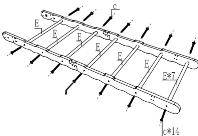
Stecken Sie 7 Stück E-Rundstäbe in die entsprechenden runden Löcher und befestigen Sie sie mit 14 Stück M6\*35-Schrauben. Nach der Installation für die spätere Verwendung beiseitelegen.
