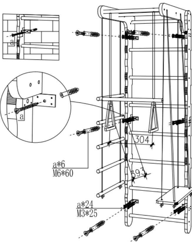
Tout d'abord, ouvrez six petits trous sur le mur adaptés aux vis M6 \* 60 en fonction de la position du trou rond central des six pièces de fer suspendues au mur du cadre d'escalade. Deuxièmement, placez le M6 \* 60 dans les trous, serrez-le. puis dévissez l'écrou, puis alignez la pièce en fer fixée au mur du cadre d'escalade avec le trou, insérez l'écrou dans le trou central de la pièce en fer et serrez. Enfin, chaque pièce de fer est à nouveau fixée avec 4 vis M3 \* 25
