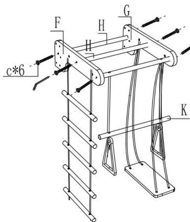
Insérez 2 bâtons ronds H et k avec anneau de levage dans F et G, et fixez-les avec 6 pièces M6\*35.
