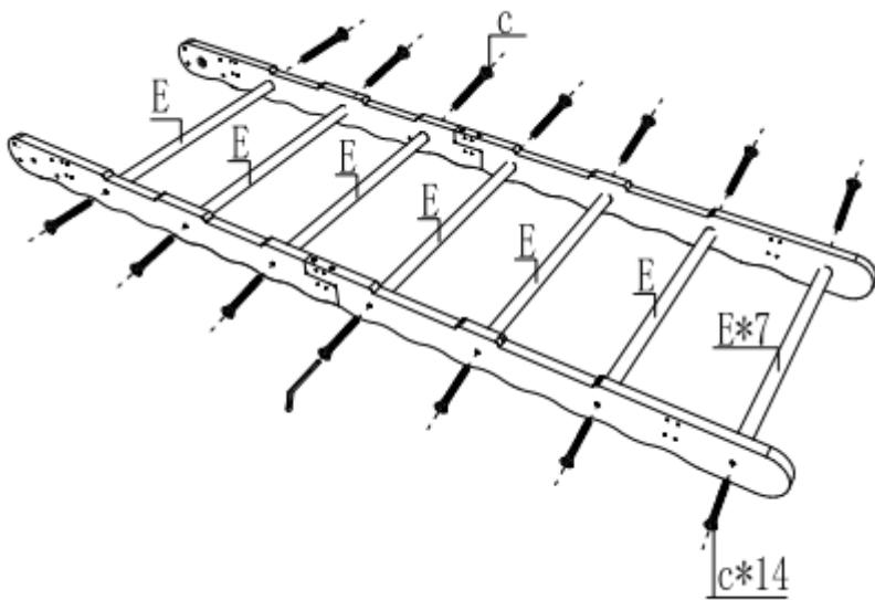
Insérez 7 bâtons ronds E dans les trous ronds correspondants et fixez-les avec 14 vis M6 \* 35. Mettre de côté pour une utilisation ultérieure après l'installation.
