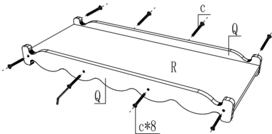
Verbinden Sie 2 Schieberseitenwände Q mit Schieber R und befestigen Sie sie mit 8 Stück M6\*35.
