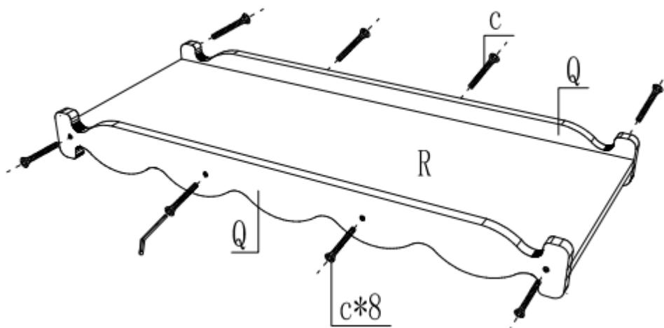
Connectez les 2 panneaux latéraux coulissants Q à la glissière R et fixez-les avec 8 pièces de M6\*35.
