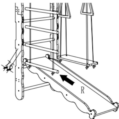
Setzen Sie den Schieber auf den ersten oder zweiten runden Stab des Hauptkörpers, und der gesamte Installationsvorgang ist abgeschlossen (**bitte platzieren Sie ihn nicht auf dem dritten oder oberen runden Stab, da dies sonst aufgrund des übermäßigen Neigungswinkels zu Gefahren führt**).
