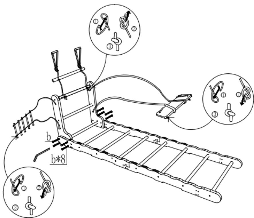
Connectez les pièces installées dans les deuxième et troisième étapes avec 8 pièces M6\*50. Mettre de côté pour une utilisation ultérieure après l'installation.
