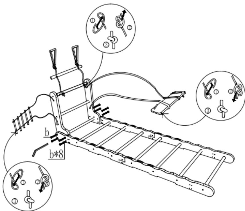
Verbinden Sie die im zweiten und dritten Schritt installierten Teile mit 8 Stück M6\*50. Nach der Installation für die spätere Verwendung beiseitelegen.
