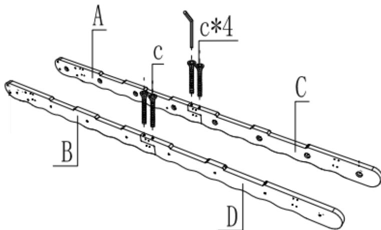
Verbinden Sie A und C, B und D entsprechend miteinander und befestigen Sie es mit 4 Stück M6\*35 Schrauben.
