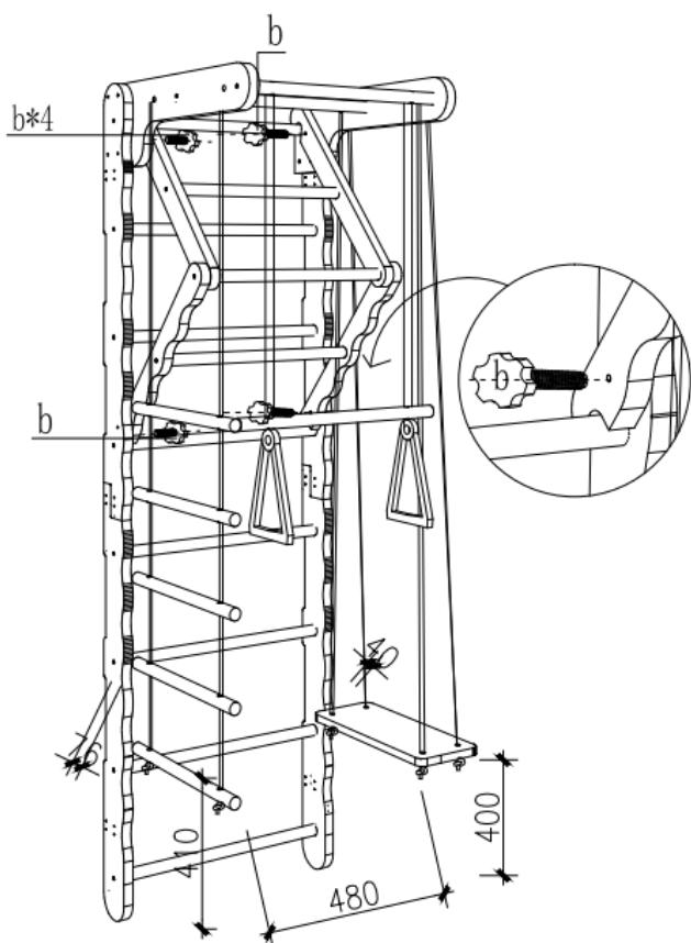
Verwenden Sie 4 M6\*30-Schrauben, um das im vierten Schritt installierte Teil im Hauptrahmen zu befestigen.
