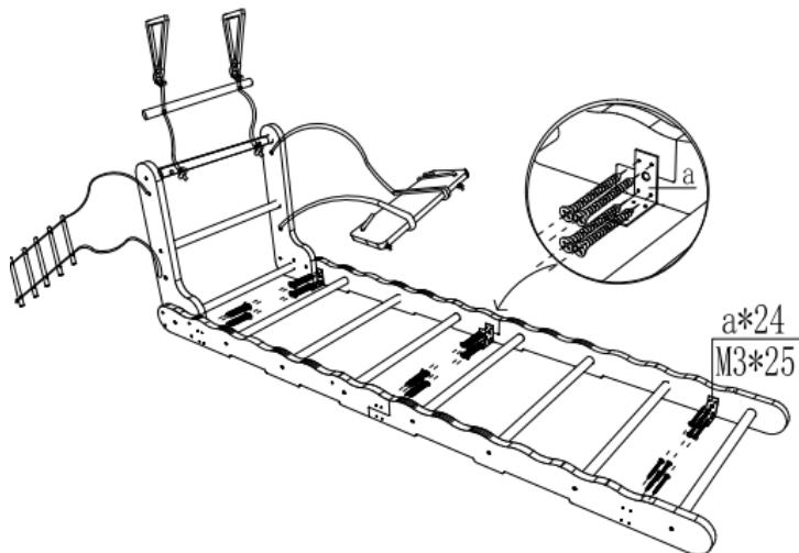
Verwenden Sie 24 Stück M3\*25-Schrauben, um wandmontiertes Zubehör und Produkthalterungen zu verbinden.
