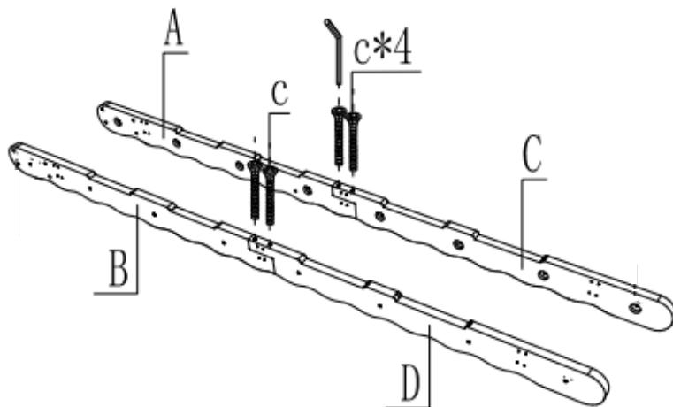
Connectez A et C, B et D en conséquence et fixez-le avec 4 vis M6 \* 35.
