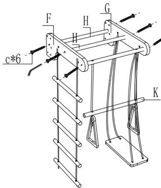
Führen Sie 2 Stück H-Rundstäbe und k mit Aufhänge-Ring in F und G ein und befestigen Sie sie mit 6 Stück M6\*35. Nach der Installation für die spätere Verwendung beiseitelegen.
