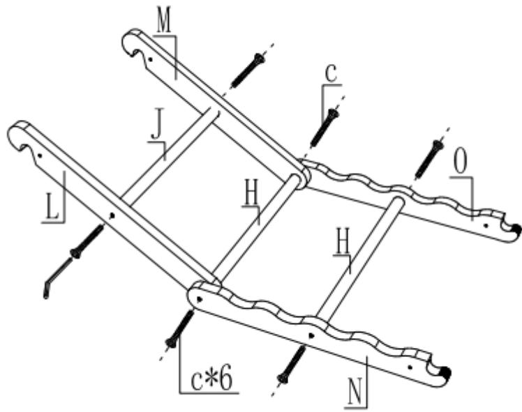
Setzen Sie 1 Stück Rundstab J in L und M ein und befestigen Sie ihn mit 2 M6\*35-Schrauben, stecken Sie dann 1 Stück Rundstab H gleichzeitig in L und M, verbinden Sie ihn mit N und O, befestigt mit 2 Stück M6\*35. Fügen Sie schließlich ein H in O und N ein und befestigen Sie es mit 2 Stück M6\*35. Nach der Installation für die spätere Verwendung beiseitelegen.
