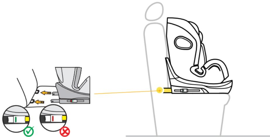
1. Klap eerst de steunpoot in. De steunpoot is niet nodig in deze lengteklasse.
