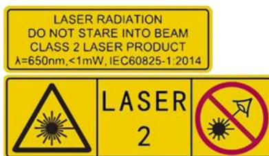
**Warnung:** Die vom Gerät abgegebene Laserstrahlung kann zu Augenverletzungen, Hautverbrennungen oder der Entzündung brennbarer Substanzen führen. Achten Sie darauf, dass niemand direkt in das Laserlicht blickt. Bevor Sie die Funktion Zusatzlicht aktivieren, vergewissern Sie sich, dass sich weder Personen noch brennbare Substanzen vor der Laserlinse befinden.
