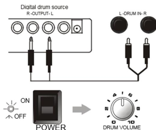
1. Verbinden Sie Ihr digitales Drumset per Audiokabel mit der Drum IN Buchse des Verstärkers während dieser ausgeschaltet ist.
