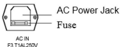
Wenn die Stromversorgung nicht mit den Anforderungen des Verstärkers übereinstimmt kann die elektrische Sicherung Schaden nehmen. Falls der Verstärker nicht normal funktioniert, lassen Sie diese Sicherung überprüfen.
