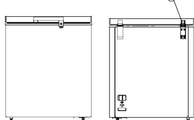
Wenn der Schließring bei der Montage des Griffs nicht gehalten hat, lösen Sie die Schrauben (5) auf der Rückseite der Tür und stellen Sie die Position der Tür oben und unten neu ein. Drehen Sie dann die Schraube wieder fest.
