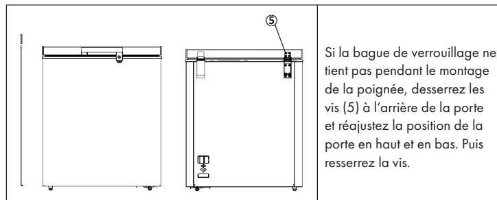
Si la bague de verrouillage ne tient pas pendant le montage de la poignée, desserrez les vis (5) à l'arrière de la porte et réajustez la position de la porte en haut et en bas. Puis resserrez la vis.
