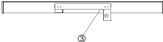
Presione la tapa de la empuñadura (3) en la empuñadura hasta que encaje.
