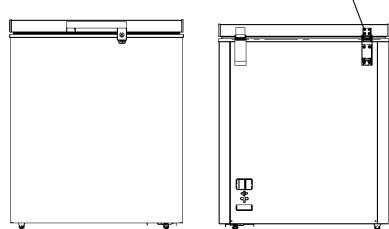
Si el anillo de bloqueo no se ha sujetado cuando se instaló la manija, afloje los tornillos (5) en la parte posterior de la puerta y reajuste la posición de la puerta en la parte superior e inferior. A continuación, vuelva a apretar el tornillo.
