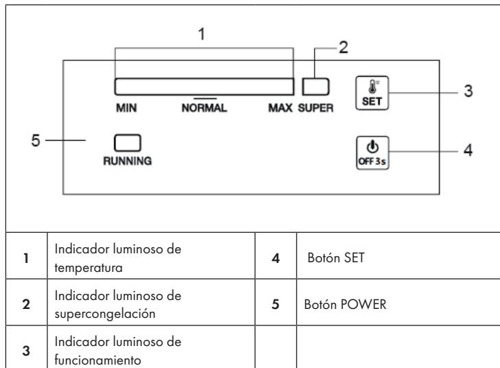
Al enchufar el conector, todas las luces se encienden brevemente. Después de eso, el dispositivo arranca con los últimos ajustes realizados.
