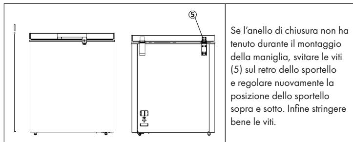
Se l'anello di chiusura non ha tenuto durante il montaggio della maniglia, svitare le viti (5) sul retro dello sportello e regolare nuovamente la posizione dello sportello sopra e sotto. Infine stringere bene le viti.
