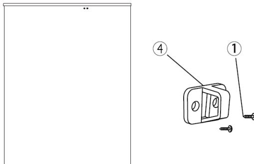
Befestigen Sie dann die Verriegelung (4) mit Schrauben am Gefrierschrank.
