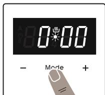
1. Druk 2 seconden lang op 'MODE' om de toetsvergrendeling te deactiveren en de stip in het midden van het scherm begint te knipperen.
