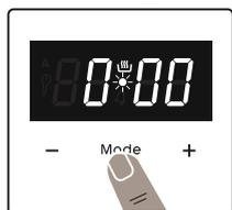
1. Drücken Sie "MODE" für 2 Sekunden, um die Tastensperre zu deaktivieren, und der Punkt in der Mitte des Bildschirms beginnt zu blinken.
