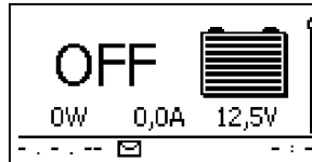
Abb. 4: Display nach dem Einschalten der externen Batteriesicherung
