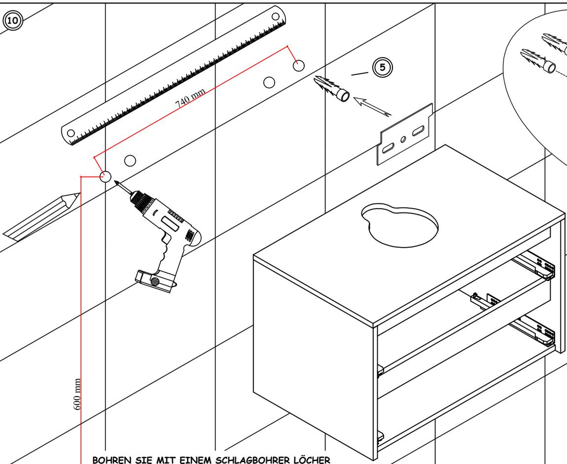
BOHREN SIE MIT EINEM SCHLAGBOHRER LÖCHER ENTSPRECHEND DER ANGEZEIGTEN ABSTÄNDE ZUR ANBRINGUNG DER AUFHÄNGUNGSELEMENTE. STECKEN SIE ANSCHLIESSEND DIE DÜBEL IN DIE LÖCHER. VERSCHRAUBEN SIE DIE AUFHÄNGUNGSELEMENTE IN DIE ANGEBRACHTEN DÜBEL.
