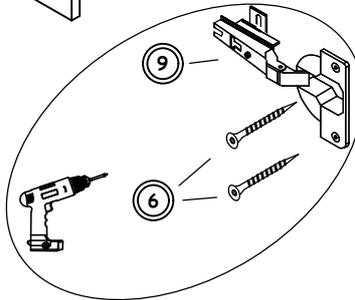
POSITIONIEREN SIE DIE BEREITS VERDÜBELTEN SCHARNIERE IN DIE OBEREN UND UNTEREN LÖCHER UND BEFESTIGEN SIE DIESE DURCH DIE ZWEI LÖCHER AM SCHRANK.
