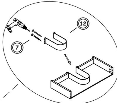
MONTIEREN SIE MIT HILFE VON SCHRAUBEN DEN ABLAUFDECKEL AN DIE RÜCKSEITE DER SCHUBLADE.
