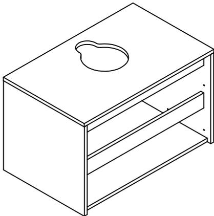
SCHIENE MIT HILFE DER EURO SCHRAUBEN AN DEN INNENSEITEN DES SCHRANKKORPUSSES AN DEN VORGESEHENEN SPUREN BEFESTIGEN. (SCHIENE WIRD VORNE AM 2. LOCH UND VON HINTEN AM 3. LOCH ANGESCHRAUBT)
