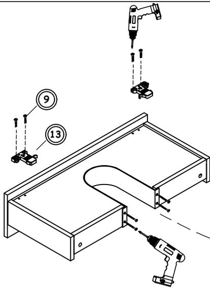
MONTIEREN SIE NACH ZUSAMMENBAU DER SCHUBLADEN DIE VERRIEGELUNGSELEMENTE (NR. 13), ENTSPRECHEND DER ANWEISUNG, AN DIE UNTERSEITEN DIESER.
