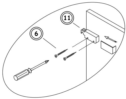
MONTIEREN SIE DAS AUFHÄNGUNGSELEMENT AN DEN SCHRANK.
