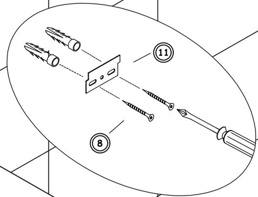
SCHRAUBEN SIE DIE AUGHÄNGUNGSELEMENTE IN DIE VORHER ANGEBRACHTEN DÜBEL. HÄNGEN SIE DANN DIE IM SCHRANK BEFINDLICHEN HAKEN AN DIE AUFHÄNGUNGSELEMENTE AN DER WAND.
