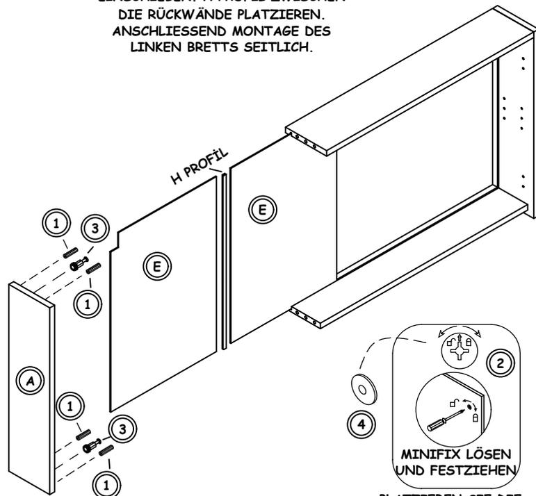
PLATZIEREN SIE DIE MINIFIX STECKER UND VERBINDERGEHÄUSE UND SCHRAUBEN SIE DIESE FEST.
