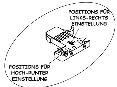
NACHDEM DIE SCHUBLADEN ANGEBRACHT SIND, KÖNNEN ÜBER DIE VERRIEGELUNGSELEMENTE LEICHTE EINSTELLUNGEN LINKS-RECHTS UND HOCH-RUNTER VORGENOMMEN WERDEN.
