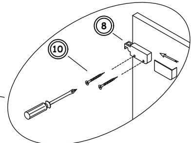
MONTIEREN SIE DAS AUFHÄNGUNGSELEMENT AN DEN SCHRANK.
