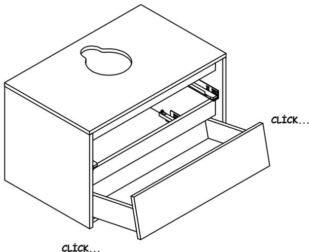
SCHIEBEN SIE DIE SCHUBLADE, ENTSPRECHEND DER ANWEISUNG AN DEN SCHIENEN EIN. ANHAND DES CLICK-GERÄUSCHS HÖREN SIE, DASS DIE SCHUBLADE NUN IN DER RICHTIGEN POSITION SITZT.
