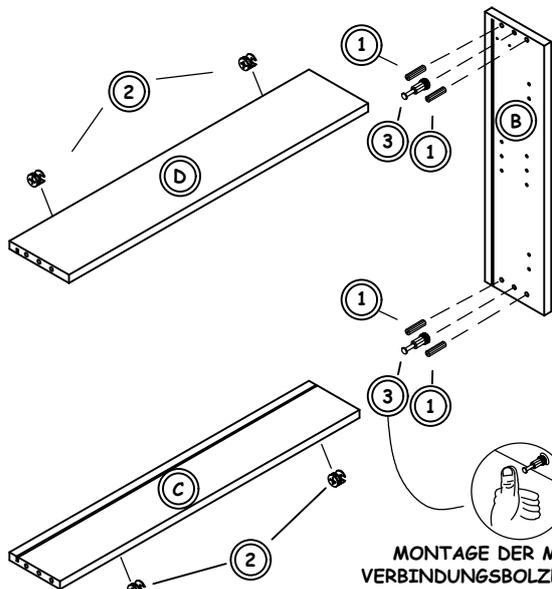
MONTAGE DER MINIFIX-VERBINDUNGSBOLZEN IM LOCH
