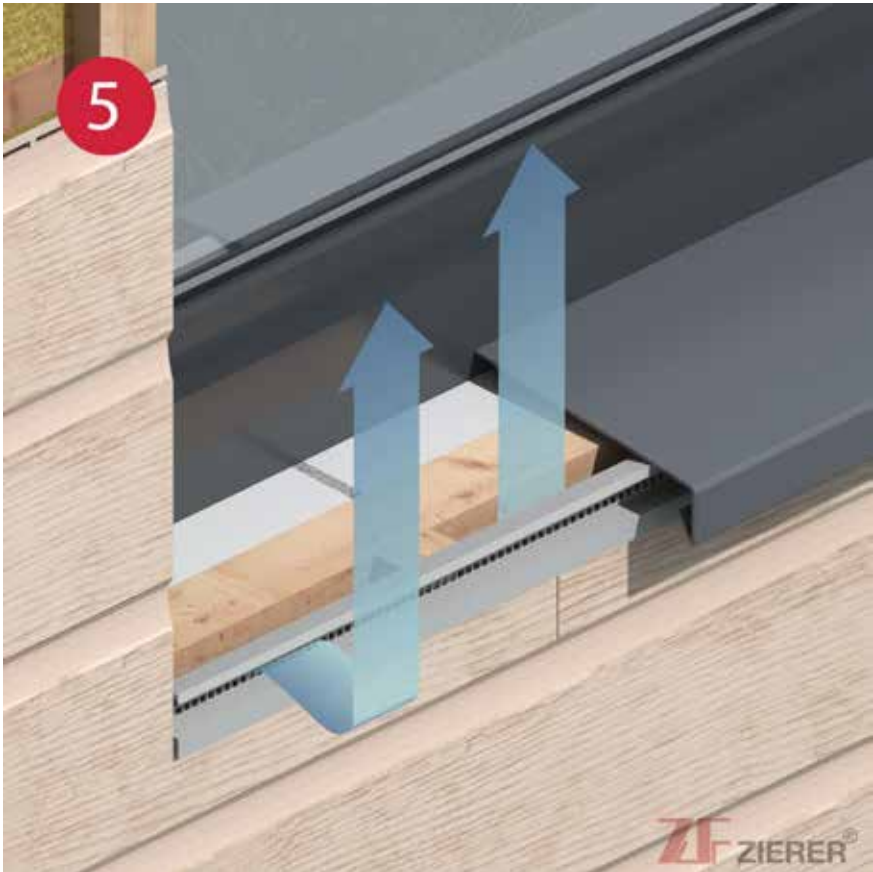
Anschlussprofil der Fassadefläche unter der Fensterbank (Entlüftung).
