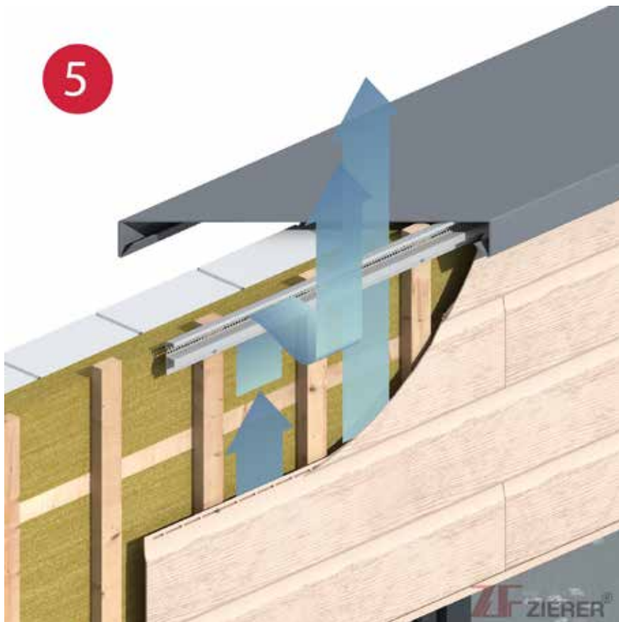
Oberer Abschluss zum Dachanschluss, Dachschräge (Entlüftung).
