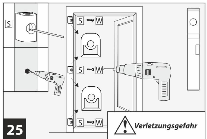
**25** Den Insektenschutzrahmen auf der Außenseite des bestehenden Türrahmens anlegen und ausrichten (Wasserwaage).
