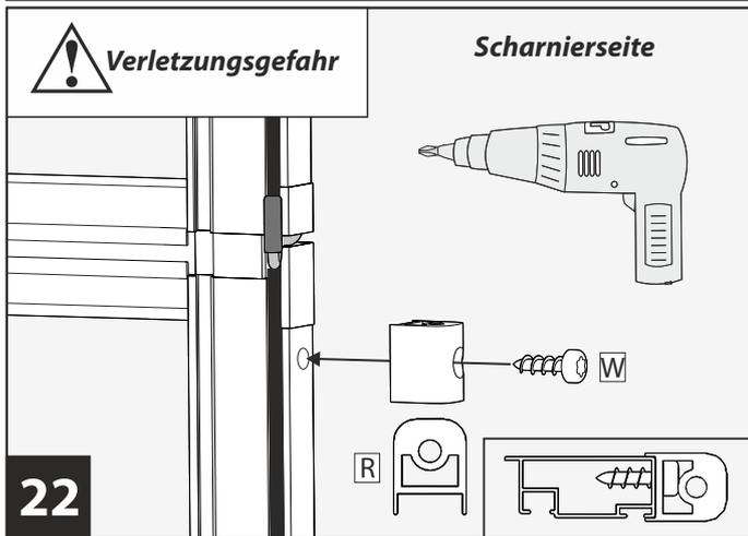
**22** **Scharnierseite:** Scharnier für die Mitte **R** mit Torx-Schraube **W** an vorgebohrter Position befestigen. **Achten** Sie bei der Anbringung auf die Richtung des Schraubloches (siehe auch Detailabbildung).
