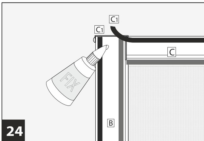
**24** Fixieren Sie den Überstand der Bürstendichtung **C1** mit doppelseitigem Klebeband oder Klebstoff (Klebeband und Klebstoff nicht im Lieferumfang enthalten).
