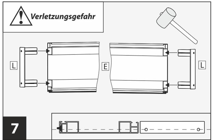
**7** Verbinder Trittschutz **L** beidseitig an das Trittschutzprofil **E** ansetzen und einschlagen. **Achtung!** Die Schraublöcher der Verbinder **L** zeigen in Richtung der glatten Außenseite des Trittschutzprofils **E** (siehe auch Detailabbildung).
