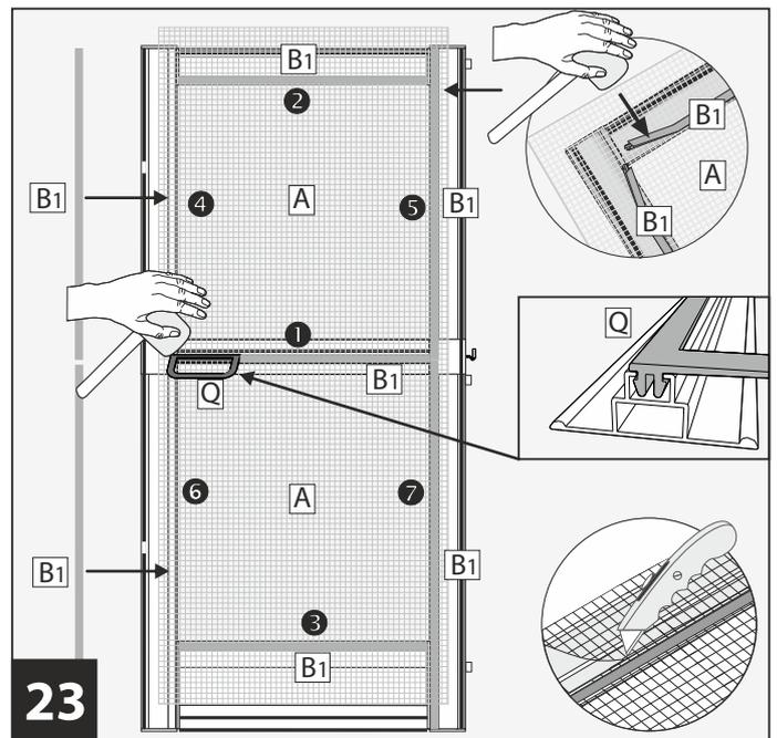
**23** Durch Eindrücken der Klemmleisten **B1** in die Nut der Aluprofile (**B C D E**) das Gewebe **A** befestigen.
