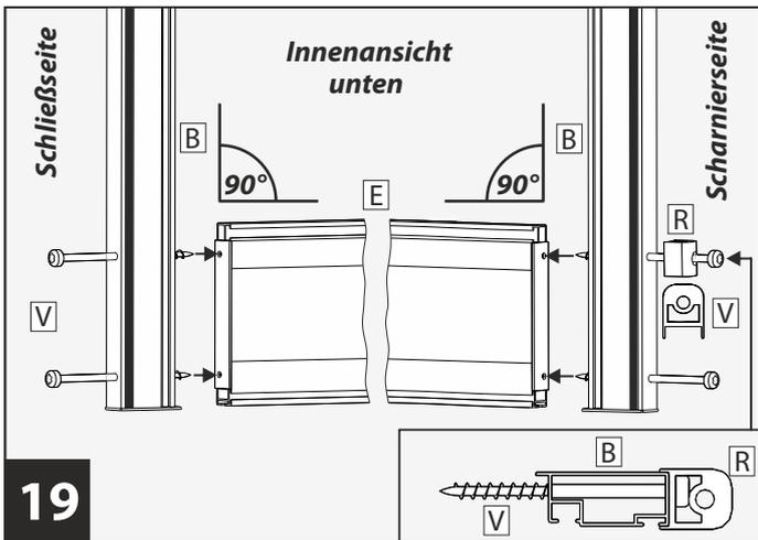
**19** Trittschutzprofil **E** und Höhenprofile **B** mit Torx-Schrauben **V** verbinden. **Achtung!** Auf Scharnierseite muss das Scharnier **R** mit der oberen Schraube **V** befestigt werden. **Hinweis:** Ziehen Sie die Schrauben im Wechsel gleichmäßig an. Die Schrauben **nur handfest** anziehen. **Bei Verwendung eines Akkuschaubers das Drehmoment reduzieren.**
