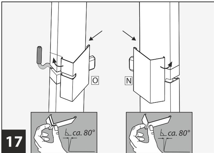
**17** Abdeckkappen aufsetzen. Dabei Abdeckkappe **N** auf Schließseite und Abdeckkappe **O** auf Scharnierseite aufsetzen. Beide Abdeckkappen von innen nach außen aufstecken und nach hinten umlegen. Abdeckkappen mittig ausrichten. **Achtung:** Abdeckkappen vor Montage ggf. noch einmal leicht auf Vorspannung (ca. 80°) biegen.
