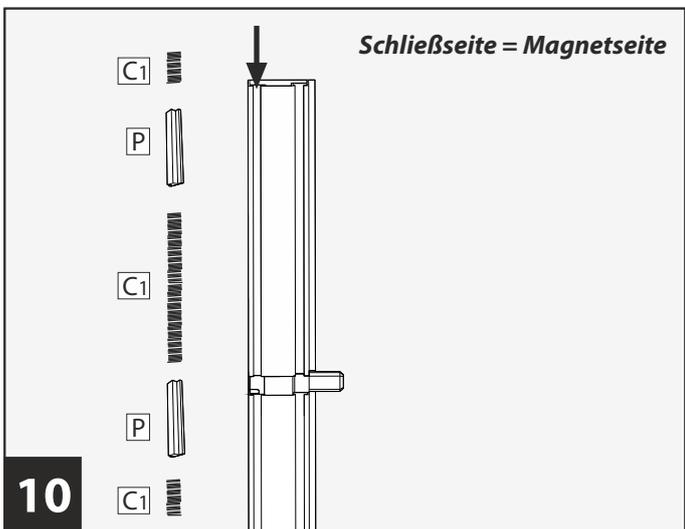
**10** Magnete **P** einsetzen. Bürstendichtung im Wechsel gemäß **C1** Abbildung in den äußeren Kanal der Höhenprofile **B** auf der Schließseite einziehen.
