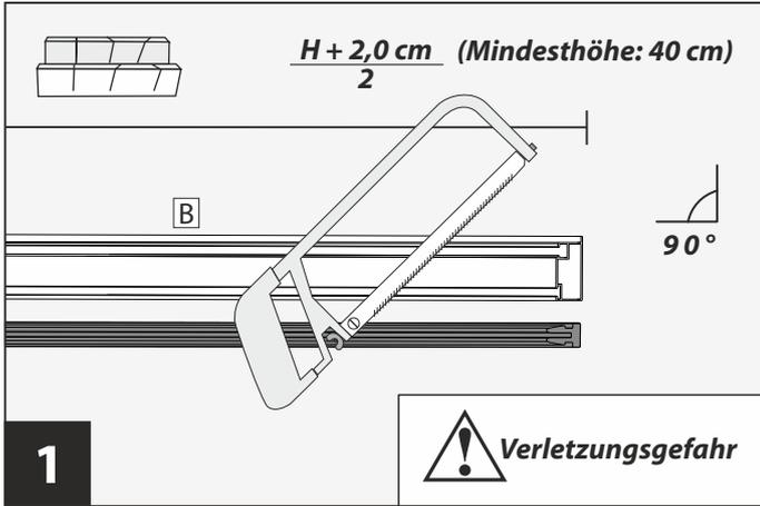
Die 4 Höhenprofile **B** auf die genaue Höhe „H“ + 2,0 cm, geteilt durch 2 kürzen. Achten Sie auf einen sauberen und geraden Schnitt. Nach Möglichkeit eine Gehrungslade verwenden.
