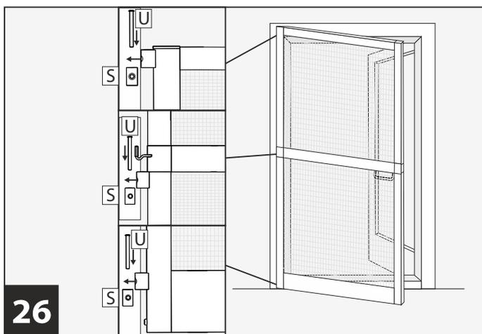
**26** Türrahmen mit drei Befestigungsstäben **U** fixieren. Dazu die Scharniere **R** mittels der Befestigungsstäbe **U** mit den Scharnierhalter **S** verbinden.
