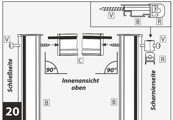
**20** Höhenprofile **B** oben mit Querprofil **C** mittels Torx-Schrauben **V** verbinden. **Achtung!** Auf Scharnierseite muss das Scharnier **R** mit der Torx-Schraube **V** befestigt werden. **Hinweis:** Ziehen Sie die Schrauben im Wechsel gleichmäßig an. Die Schrauben **nur handfest** anziehen. **Bei Verwendung eines Akkuschaubers das Drehmoment reduzieren.**
