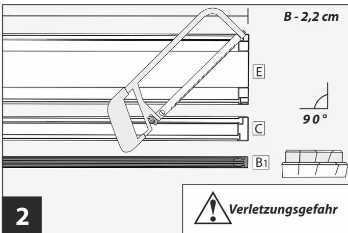
Das Querprofil **C**, Trittschutzprofil **E** und 2 Stück Klemmleisten **B1** auf das Maß „B“ - 2,2 cm kürzen.
