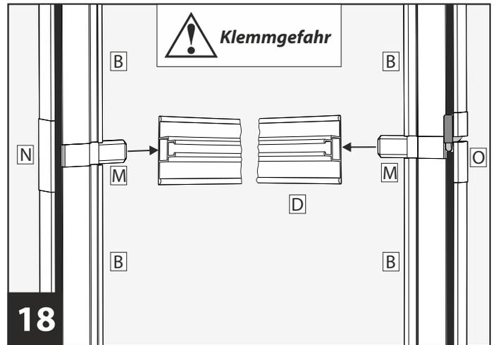
**18** Vorbereitete Höhenprofile **B** mit Griffprofil **D** verbinden. **Achten** Sie darauf, dass die Abdeckkappen **N** und **O** an den Mittelverbindern **M** mittig ausgerichtet sind.
