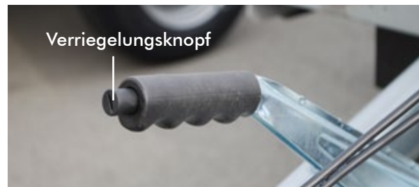
Handbremshebel mit seitlichen Zahnsegment (Abb. abweichend)
