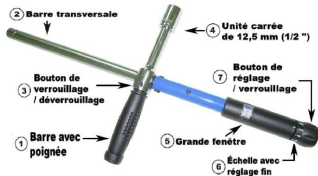
a) Appuyez sur le bouton de verrouillage/déverrouillage (3), faites glisser l'arbre de la poignée (1) jusqu'à l'extrémité de l'arbre transversal (2) et verrouillez.
