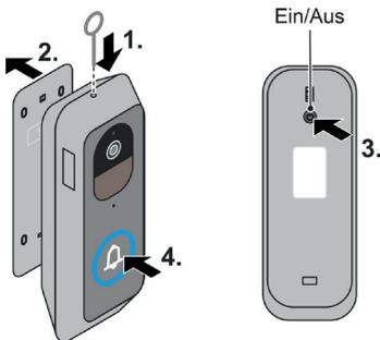
1. Nehmen Sie die Klingel von der Montageplatte durch Lösen der Verriegelung mit Hilfe des mitgelieferten Werkzeugs.
