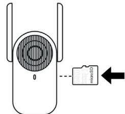
**TIPP:** Um eine Karte zu entnehmen, drücken Sie sie in Richtung Einschub und lassen Sie sie los. Dadurch springt die Karte aus der Verriegelung und kann entnommen werden.
