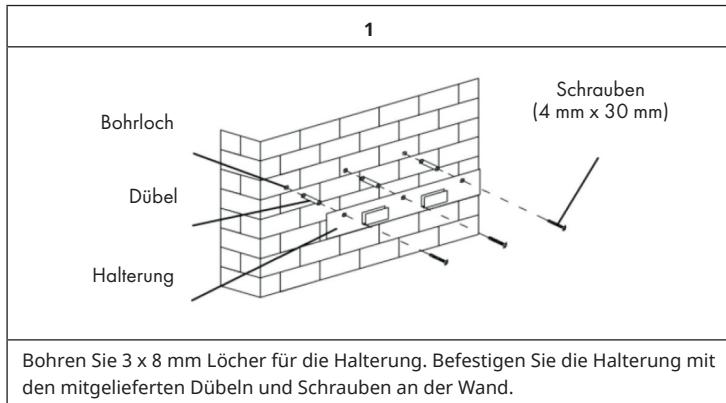
Bohren Sie 3 x 8 mm Löcher für die Halterung. Befestigen Sie die Halterung mit den mitgelieferten Dübeln und Schrauben an der Wand.
