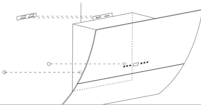
Pour les modèles obliques, vous devez percer quatre trous supplémentaires (8 mm) avant le montage. Insérez les chevilles et les vis avant d'accrocher le capot au mur.
