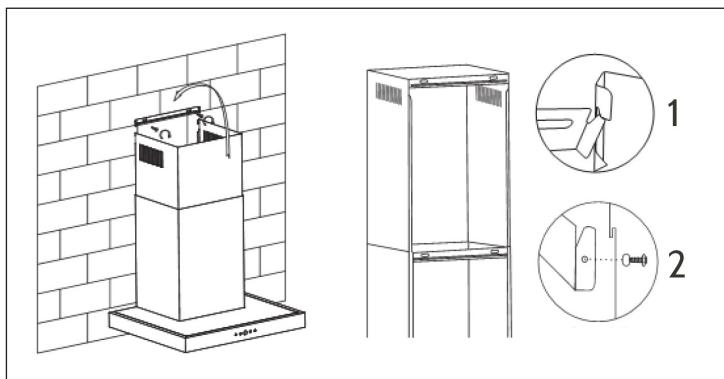
1. Nachdem Sie die 2 Löcher gebohrt und den Haken befestigt haben, hängen Sie den Innenkamin an den beiden Seitenverriegelungen auf (Bild 1).
