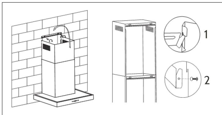
1. Après avoir percé les 2 trous et fixé le crochet, accrochez la cheminée intérieure par aux deux verrous latéraux (schéma 1).
