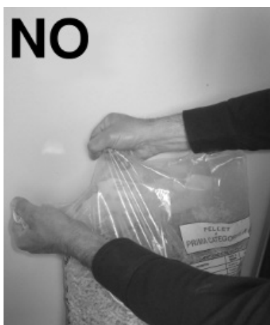
Fig. 18 - Fehlerhafte Öffnung des Pelletsacks
