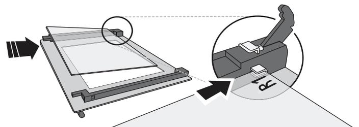
**4.** Die obere Ecke wieder anbringen: ein Klick bestätigt die richtige Positionierung. Sicherstellen, dass die Dichtung vor Wiedereinbau der Tür befestigt wird.
