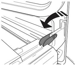
**2.** Die Tür so weit wie möglich schließen. Die Tür mit beiden Händen festhalten – diese nicht am Griff festhalten. Die Tür einfach entfernen, indem sie weiter geschlossen und gleichzeitig nach oben (a) gezogen wird, bis sie sich aus ihrem Sitz löst (b).
