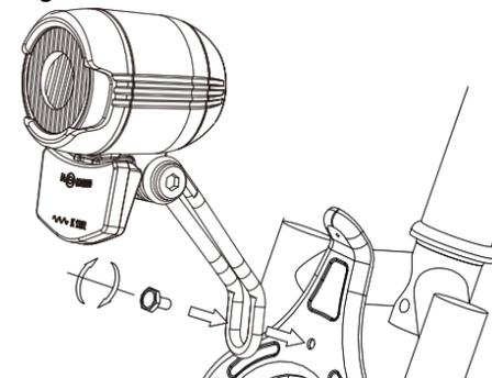
Schieben Sie den Scheinwerfer in vorhergesehene Öffnung des Rahmens. Fixieren Sie den Scheinwerfer ① mit einer Schraube.
