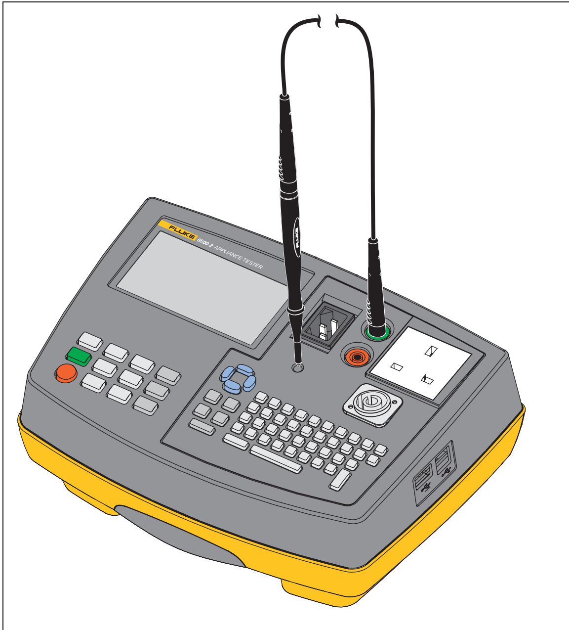
Abbildung 1. Kompensation der Messleitung
