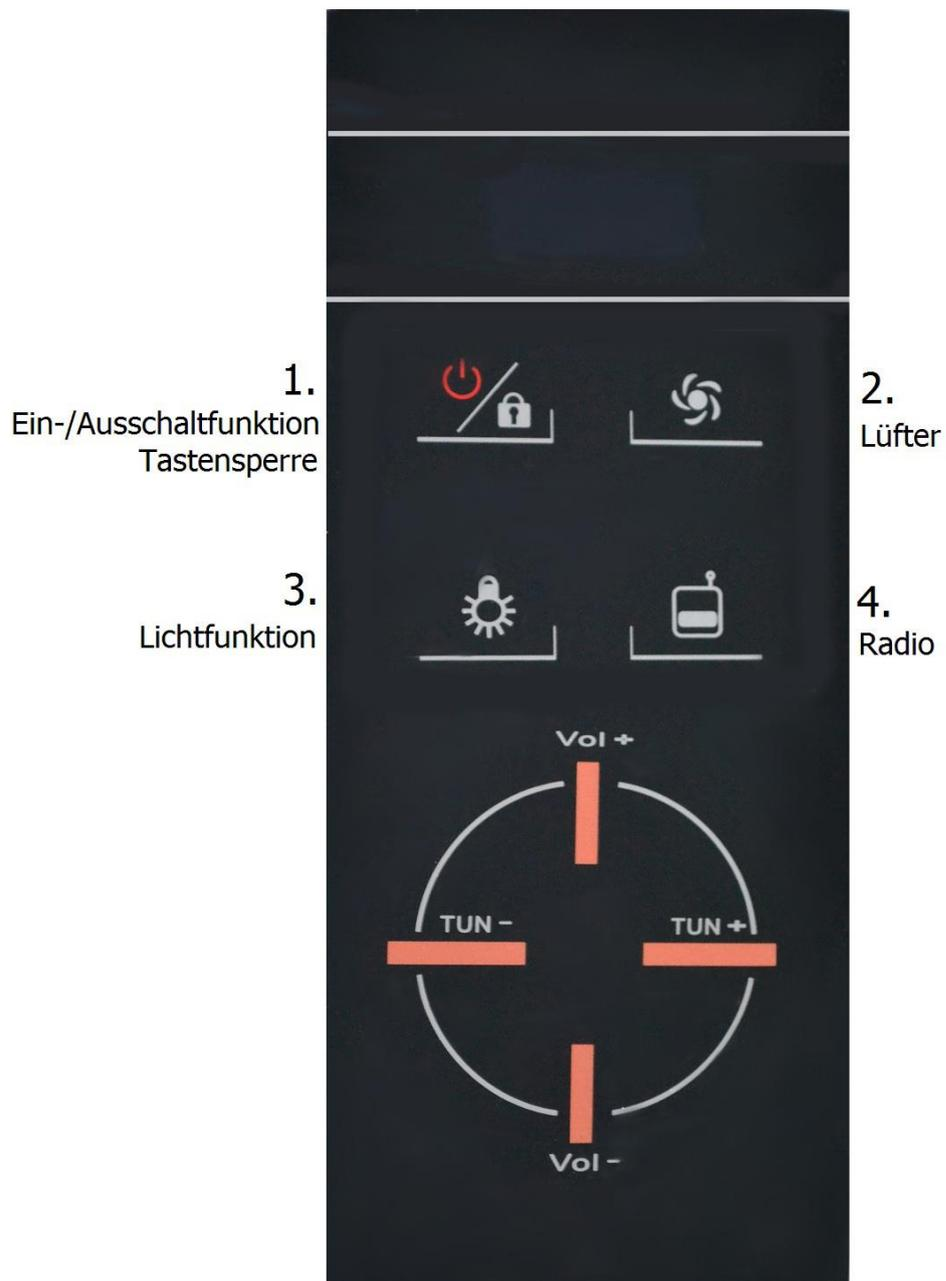
Sender und Volumen werden über die linke und rechte, sowie über die oben und unten Tasten eingestellt.
