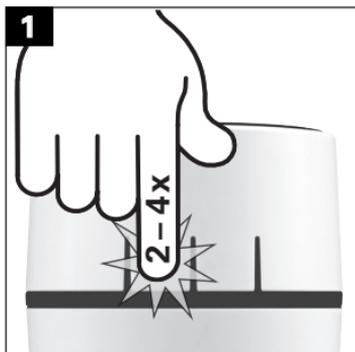
Drücken Sie die **Auswahltaste** im Grundzustand **2-, 3- oder 4-mal** im Abstand von einer Sekunde, um die Schlummerfunktion für **1, 3 oder 9 Stunden** zu aktivieren.
