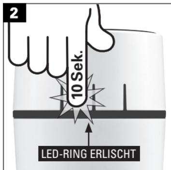
Betätigen Sie **innerhalb von 7 Sekunden die Auswahltaste** und halten Sie sie **10 Sekunden lang gedrückt**. Als Bestätigung erlischt der LED-Ring.
