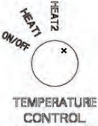
Der Temperaturregler stellt sicher, dass das Gerät nicht heiß laufen wird. Wenn die Heizung eine unsichere Temperatur erreicht, schaltet sie sich automatisch aus. Gelangt die Heizung wieder zu einer sicheren Temperatur, arbeitet sie weiter.
