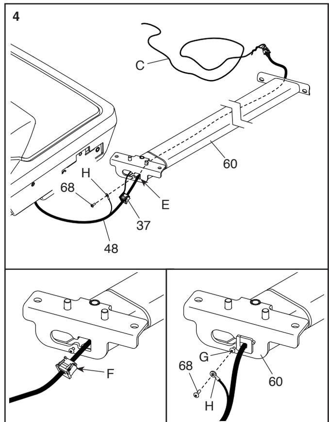
**5. Klemmen Sie das Pfostenkabel (48) bei diesem Schritt nicht ein.**
