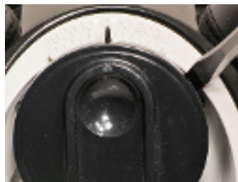
9.2: Verwenden Sie einen flachen Schraubenzieher, um die Klappeneinheit wie gezeigt auszurichten
