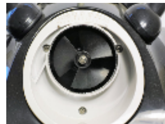
9.3: Lassen Sie die Klappeneinheit nach dem Reinigen wieder einschnappen.
