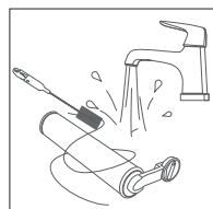
Fig. 15 – Limpieza del rodillo de microfibra
