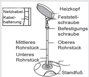
Setzen Sie jetzt den Heizkopf (siehe Abb. 1d) auf das obere Rohrstück und ziehen Sie die Feststellschraube kräftig an. Fixieren Sie das Netzkabel mit Hilfe der Kabelhalterung.
