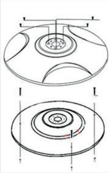
Verbinden Sie den schweren Standfuß mit einem festen Untergrund. Verwenden Sie hierfür die beige-fügten Dübel und Schrauben. Es werden 3 Schrauben (M4 x 35) benötigt um den Standfuß am Boden zu befestigen. Verbinden Sie danach die dekorative Abdeckung mit dem Standfuß. Beachten Sie dabei die vorgesehenen Löcher in der Abdeckung und verwenden Sie 4 der im Lieferumfang enthaltenen Schrauben. (M6 x 30)
