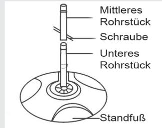
Verbinden Sie nun das untere (siehe Abb. 1b) mit dem mittleren Rohrstück (siehe Abb. 1b) indem Sie die Schrauben (3 x M5 x 6) in die Öffnungen einschrauben.
