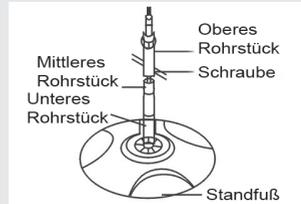
Befestigen Sie das obere Rohrstück (siehe Abb. 1c) mit dem mittleren Rohrstück. Nutzen Sie hierfür die dafür vorgesehenen Schrauben (3 x M5 x 6).
