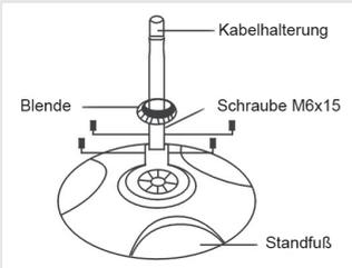
Befestigen Sie zunächst das untere Rohrstück (siehe Abb. 1a) am Standfuß (siehe Abb. 1a), indem Sie die Schrauben in die dafür vorgesehenen Öffnungen am Fuß einschrauben. Anschließend stecken Sie die Kabelhalterung auf das untere Rohrstück.
