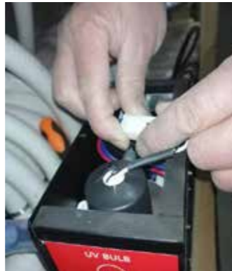
7. Schritt: Weiße Verbindungsstücke wieder verkuppeln
