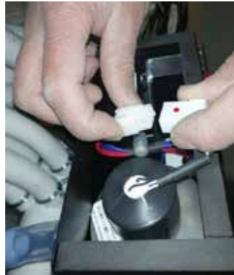
3. Schritt: Weiße Verbindungsstücke entkuppeln
