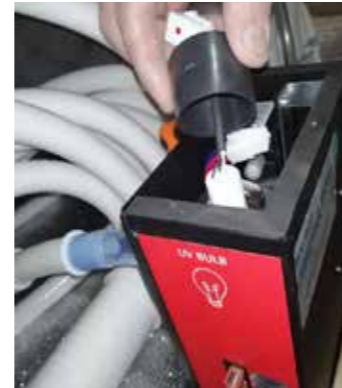
4. Schritt: Schwarze Abdeckung herausnehmen
