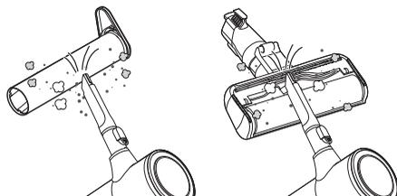
**4** Verwenden Sie ein feuchtes Handtuch oder Tuch, um restliche Fremdkörper und Staub von der Bürste und der Unterseite des Aufsatzes zu entfernen. Entfernen Sie Fremdkörper, Ablagerungen und Haare mit einer Pinzette von allen Rollen der Aufsätze.
