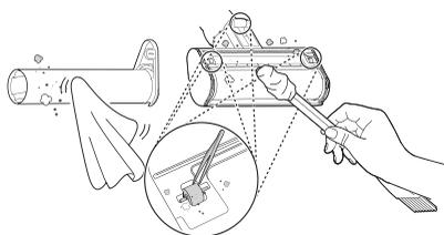
**6** Schieben Sie die Bürste zurück in den Aufsatz und drehen Sie die Abdeckung wieder an ihren Platz. Drehen Sie die Abdeckungssperre im Uhrzeigersinn, um die Abdeckung zu sperren.
