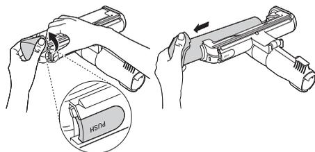
**3** Bringen Sie den Fugenaufsatz am Produktgehäuse an und verwenden Sie den Staubsauger, um Fremdkörper und Staub von der Bürste und der Unterseite des Aufsatzes zu entfernen.
