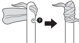
**10** Drehen Sie das Produktgehäuse um, heben Sie den Kompressorhebel **8** an und reinigen Sie die Innenseite der Arbeitsplatte mit dem in das Papiertuch gewickelten Bürstengriff.
