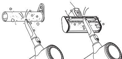
**5** Verwenden Sie ein feuchtes Handtuch oder Tuch, um restliche Fremdkörper und Staub von der Bürste und der Unterseite des Aufsatzes zu entfernen. Entfernen Sie Fremdkörper, Ablagerungen und Haare mit einer Pinzette von allen Rollen der Aufsätze.
