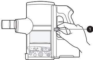
**3** Drücken Sie den Auslöseknopf **2** der Staubbehälterabdeckung, um die Staubbehälterabdeckung zu öffnen. Schütteln Sie den Staubbehälter, um diesen zu entleeren.
