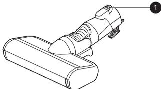
**2** Stellen Sie den Aufsatz auf den Kopf und entfernen Sie die rotierende Bürste, während Sie die **PUSH**-Taste an dem Aufsatz gedrückt halten.
