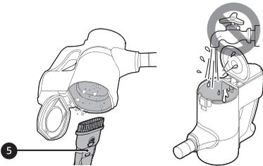
**7** Drehen Sie das Produktgehäuse um und heben Sie den Kompressorhebel **6** an, um die Innenseite der Arbeitsplatte mit der mitgelieferten Reinigungsbürste zu reinigen.
