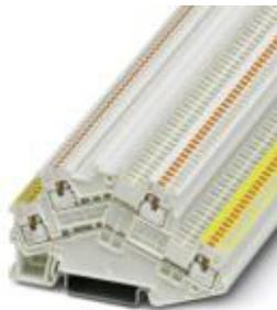
Doppelstockklemme, für KNX-Bus in der Gebäudeinstallation, Anschlussart: Push-in-Anschluss, Querschnitt: 0,14 mm<sup>2</sup> - 1,5 mm<sup>2</sup>, AWG: 26 - 14, Breite: 3,5 mm, Farbe: weiß, Montageart: NS 35/7,5, NS 35/15
