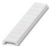
Zackband flach, Streifen, weiß, unbeschriftet, beschriftbar mit: PLOTMARK, CMS-P1-PLOTTER, Montageart: verrasten in flacher Schildchennut, für Klemmenbreite: 3,5 mm, Schriftfeldgröße: 3,5 x 5,2 mm, Anzahl der Einzelschilder: 10
