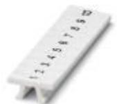
Zackband, Streifen, weiß, beschriftet, längs bedruckt: fortlaufende Zahlen, 1 ... 10, 11 ... 20 usw. bis 91 ... 100, Montageart: verrasten in hoher Schildchennut, für Klemmenbreite: 3,5 mm, Schriftfeldgröße: 3,5 x 10,5 mm, Anzahl der Einzelschilder: 10
