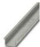
Tragschiene ungelocht, Standardprofil 2,3 mm, Breite: 35 mm, Höhe: 15 mm, nach EN 60715, Material: Stahl, verzinkt, dickschichtpassiviert, Länge: 2000 mm, Farbe: silberfarben
