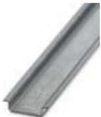
Tragschiene ungelocht, Standardprofil, Breite: 35 mm, Höhe: 7,5 mm, nach EN 60715, Material: Stahl, verzinkt, Länge: 2000 mm, Farbe: silberfarben
