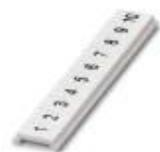
Zackband flach, Streifen, weiß, beschriftet, längs bedruckt: fortlaufende Zahlen 1 ... 10, 11 ... 20 usw. bis 91 ... 100, Montageart: verrasten in flacher Schildchennut, für Klemmenbreite: 3,5 mm, Schriftfeldgröße: 5,15 x 3,5 mm, Anzahl der Einzelschilder: 10
