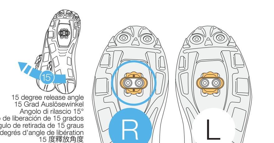
Pedal installation / Pedalmontage / Installazione dei pedali / Instalación del pedal
