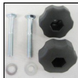
2 x Matice M8 s hlavicí 2 x Podložka 15,8 x 8,5 x 1,1 2 x Šroub s plochou kulovou hlavou M8 x 60
