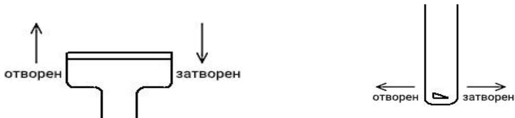
**4.2 Управление на вторичен и третичен въздух.** Контролира се чрез механизъм за регулация чрез напълно затваряне или отваряне на входа за въздуха, който идва над вратата или откъм гърба на камината. В схема 2 са показани различните механизми.
