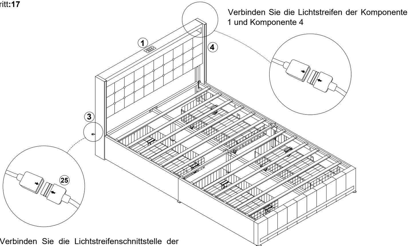
Verbinden Sie die Lichtstreifenschnittstelle der Komponente 3 mit dem Netzkabel der Komponente 25
