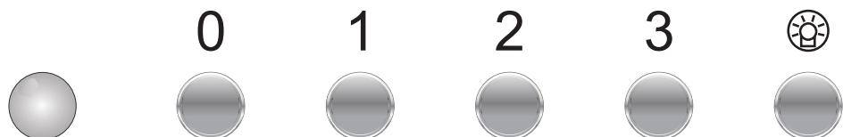
Upravljačka ploča je opremljena tipkama (isostat). Za uključivanje nape izabrati jednu od niže opisanih brzina pritiskanjem odgovarajuće tipke:
